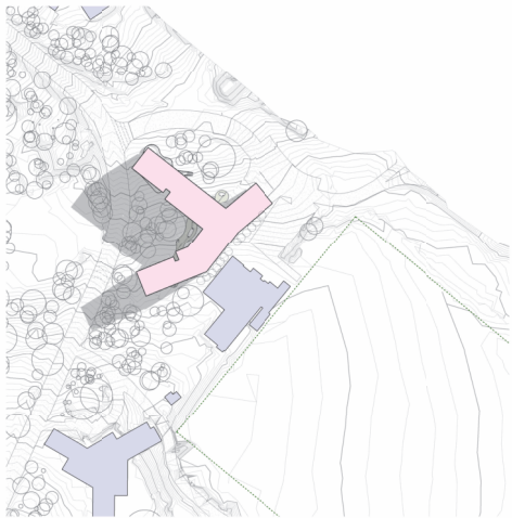
1 SHADOW DIAGRAM - SEPTEMBER 22 - 9AM SCALE 1:500
